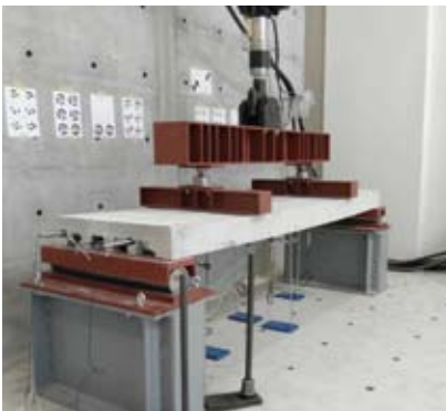
Εικόνα 5. Δοκιμή κάμψης σύμμικτης πλάκας για τον προσδιορισμό των συντελεστών m και k στο Εργαστήριο Κατασκευών του Τεχνολογικού Πανεπιστημίου Κύπρου
