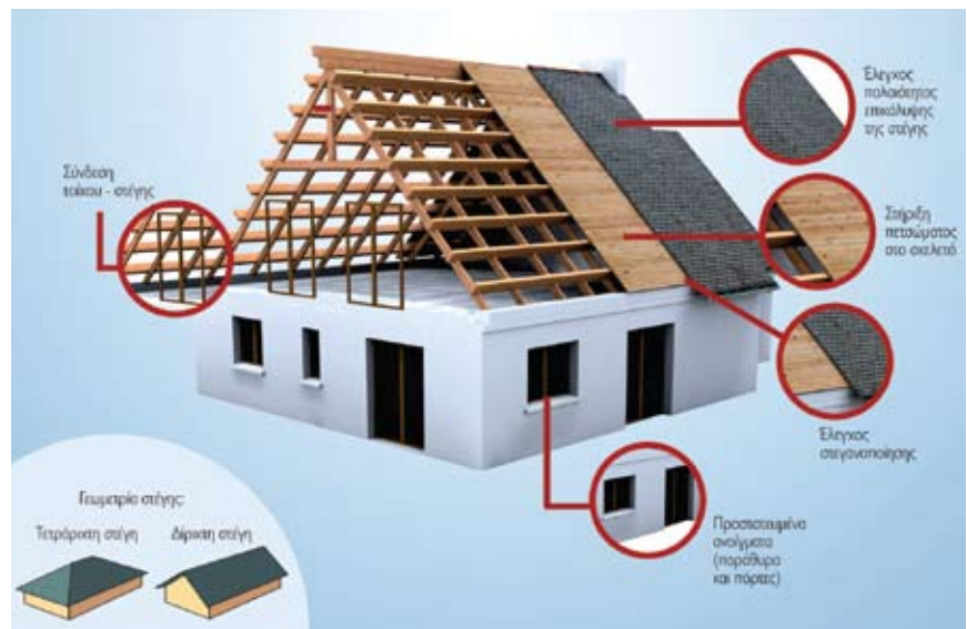
Επιθεώρηση κτιρίου για τη μείωση των πιθανών βλαβών λόγω ανέμου.
