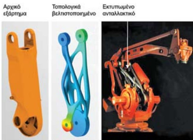
Σχήμα 7: Τρισδιάστατα εκτυπωμένο ανταλλακτικό ρομποτικού βραχίονα. Πηγή: [5]
