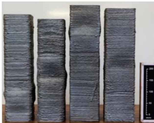
Σχήμα 8: Δοκιμές σε τρισδιάστατα εκτυπωμένα υποστυλώματα. Πηγή: [13]
