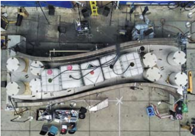
Σχήμα 9: Δοκιμές πλήρους κλίμακας στη Γέφυρα MX3D Πηγή: [13]
