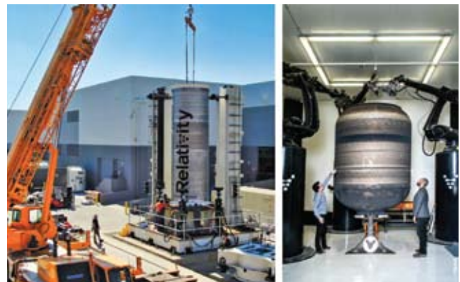
Σχήμα 2: Μέρη τρισδιάστατα εκτυπωμένου πυραύλου από την Relativity Space. Πηγές: [6,7]
