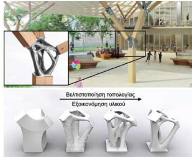
Σχήμα 5: Τοπολογικά βελτιστοποιημένη και τρισδιάστατα εκτυπωμένη χαλύβδινη σύνδεση. Πηγή: [5]
