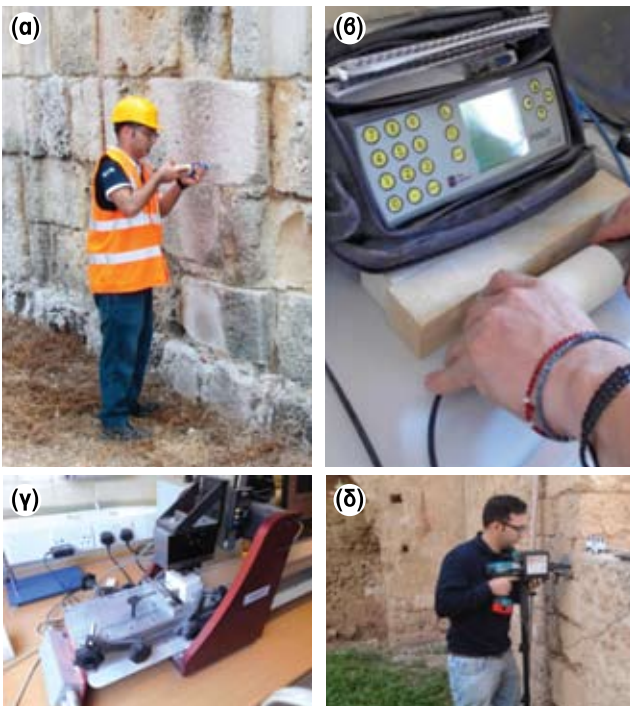
Εικόνα 5. Μικρο- και μη-καταστρεπτικές μέθοδοι έμμεσης εκτίμησης των μηχανικών ιδιοτήτων των υλικών: (α) Δοκιμή κρουσιμέτρησης σε δομικό λίθο στο ναό του Αγίου Φίλωνος στην Καρπασία. (β) Εργαστηριακή εφαρμογή της δοκιμής υπερήχων σε δοκίμιο δομικού λίθου. (γ) Εργαστηριακή εφαρμογή της δοκιμής χαραγής σε δοκίμιο ασβεστοκονιάματος (δ) Δοκιμή μικροδιάτρησης σε δομικό λίθο στην εκκλησία των Καρμελιτών στην Αμμόχωστο.
