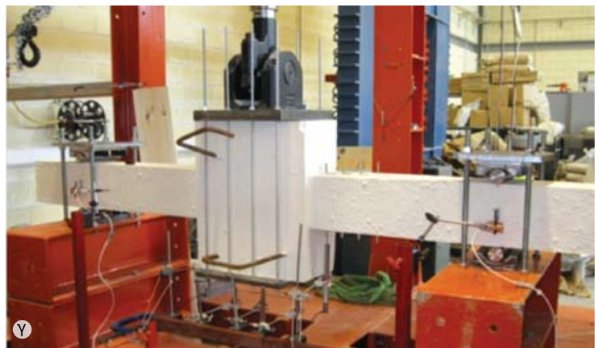
Εικόνα 1. Πειραματικοί έλεγχοι στα Εργαστήρια Δομικών Υλικών και Κατασκευών: (α) προσδιορισμός μέτρου ελαστικότητας φυσικού δομικού λίθου, (β) προσδιορισμός θλιπτικής αντοχής τοιχοποιίας από οπτόπλινθους και (γ) δοκιμή ανακυκλιζόμενης φόρτισης σε δοκούς οπλισμένου σκυροδέματος
