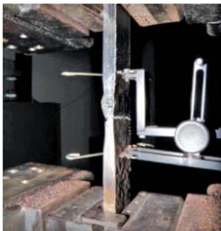
Σχήμα 18: Άποψη δοκιμίου για δοκιμή συγκολλησιμότητας
