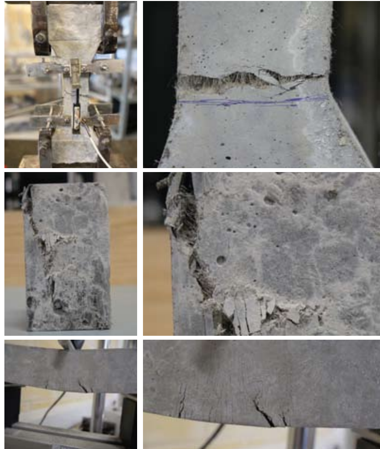
Εικόνα 2. (Πάνω) Εφελκυσμός, (Μέση) Θλίψη, (Κάτω) Κάμψη
