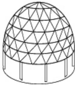
Σχήμα 2: Ο γεωδαιτικός θόλος στο Bennington College στις Η.Π.Α. (1949), με ράβδους από κράματα αλουμινίου, του Richard B. Fuller.
