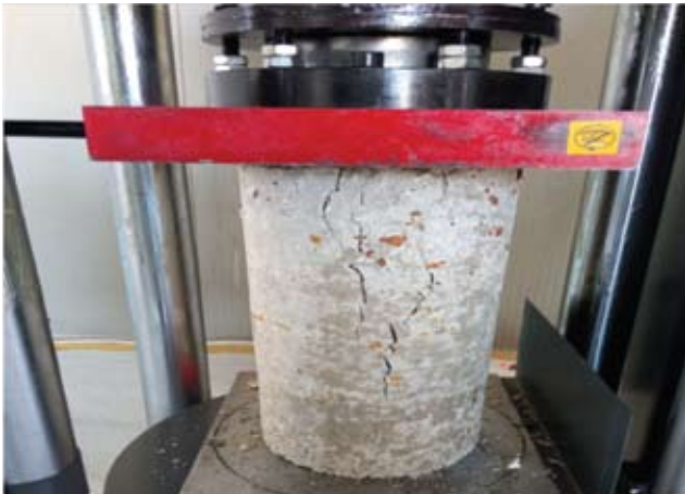
Φώτο 3. Θραύση δοκιμίων σκληρού επιχώματος
