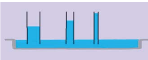
Σχήμα 5: Αναπαράσταση των πόρων του σκυροδέματος, οι οποίοι ενδέχεται να προκαλέσουν την εμφάνιση του τριχοειδούς φαινομένου για πολύ μικρές διαμέτρους.
