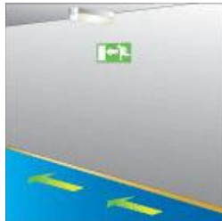
Σήμανση ασφάλειας και οδεύσεων διαφυγής
