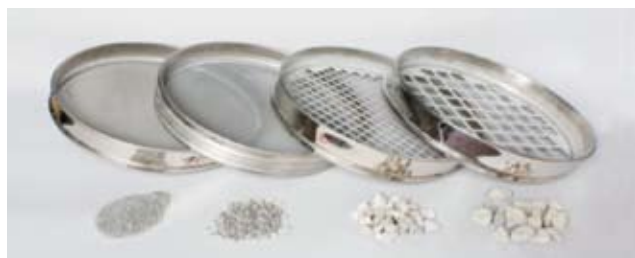
Σχήμα 2: Κόσκινα διαφόρων διαμέτρων σύμφωνα με το πρότυπο EN 12620:2002+A1:2008.
