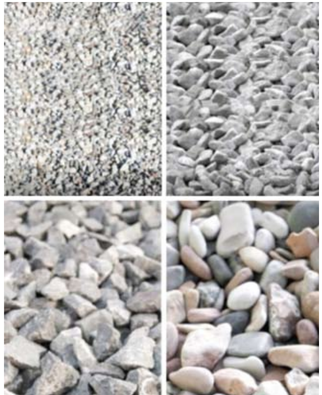
Εικ. 4: Διάφοροι τύποι ανακυκλωμένων και θρυμματισμένων αδρανών υλικών για παραγωγή σκυροδέματος. Πηγή 7
